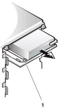
図11. ドライブベイからのディスクドライブの取り外し
