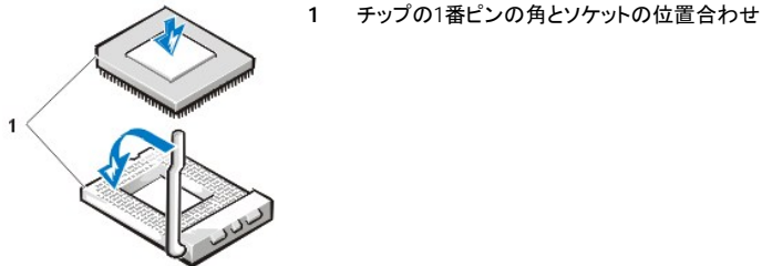
図32. マイクロプロセッサチップの取り付け
