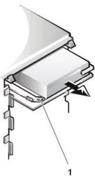
図13. 新しいドライブへのドライブブラケットの取り付け
